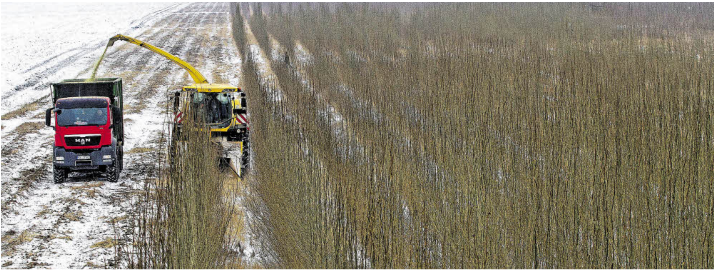
Winterliche Holzernte im Havelland: Kurzumtriebsplantage in Schmergow. Das Holz wird zu Hackschnitzeln verarbeitet, die dann in Biomasseheizkraftwerken zur klimaneutralen Erzeugung von Wärme und Strom eingesetzt werden.
