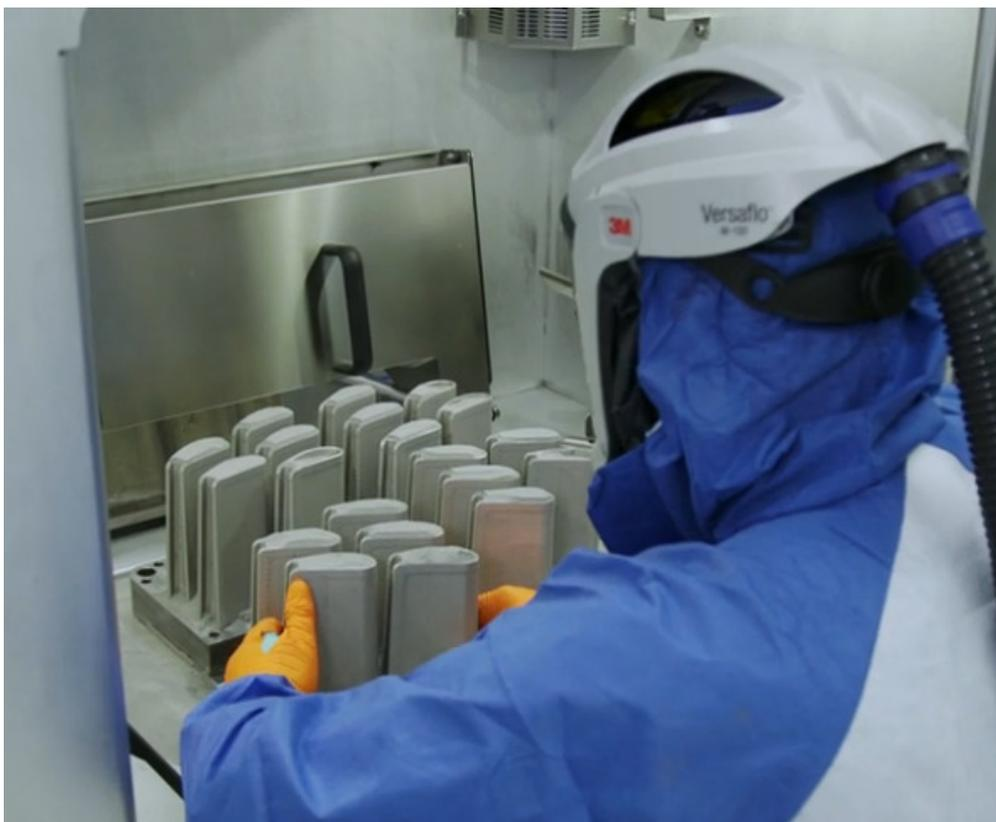
Abb.6: Fertigungsschritt des 3D Druckes der TULE1 im MXL2 mit AMP Upgrade
