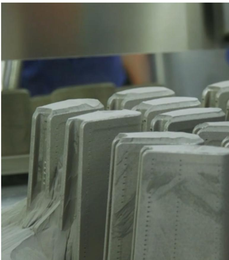
Abb.7: 3D Druck einer Komponente des MXL2 mitAMP Upgrade
