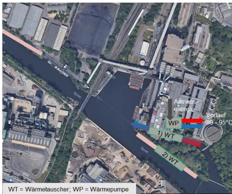
Abbildung 50: Konzepte zur Entnahme des Flusswassers der Spree<sup>87</sup>
