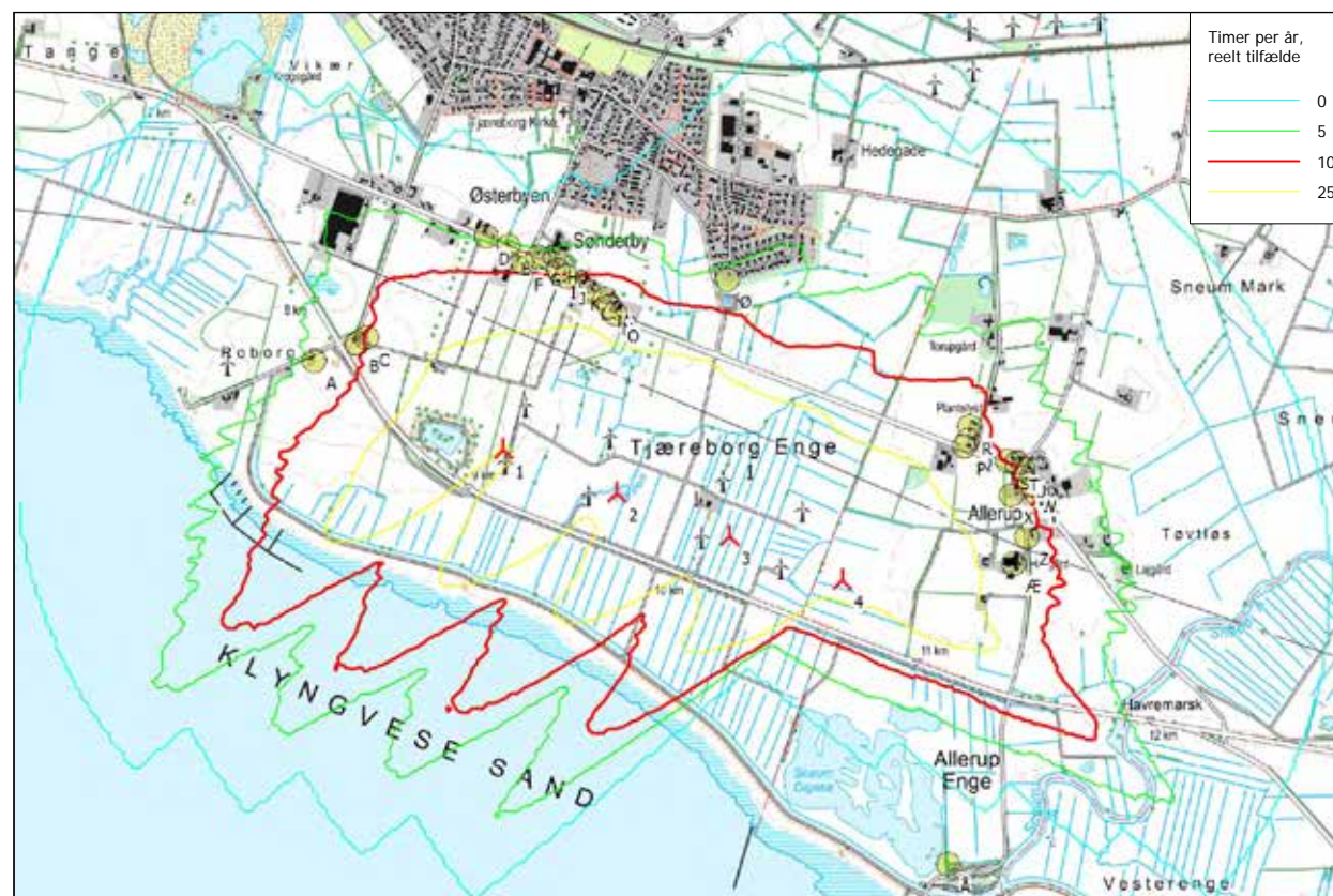
Figur 4.34. Kort over udbredelse af beregnet skygge- kast i projektforslaget ved opstilling af Siemens Gamesa SG155 og nedtagning af alle 8 eksisterende møller i Tjæreborg Enge. Linjerne viser skygge- kast i timer pr. år beregnet som reel værdi. Rød angiver grænseværdien på 10 timer pr. år.
