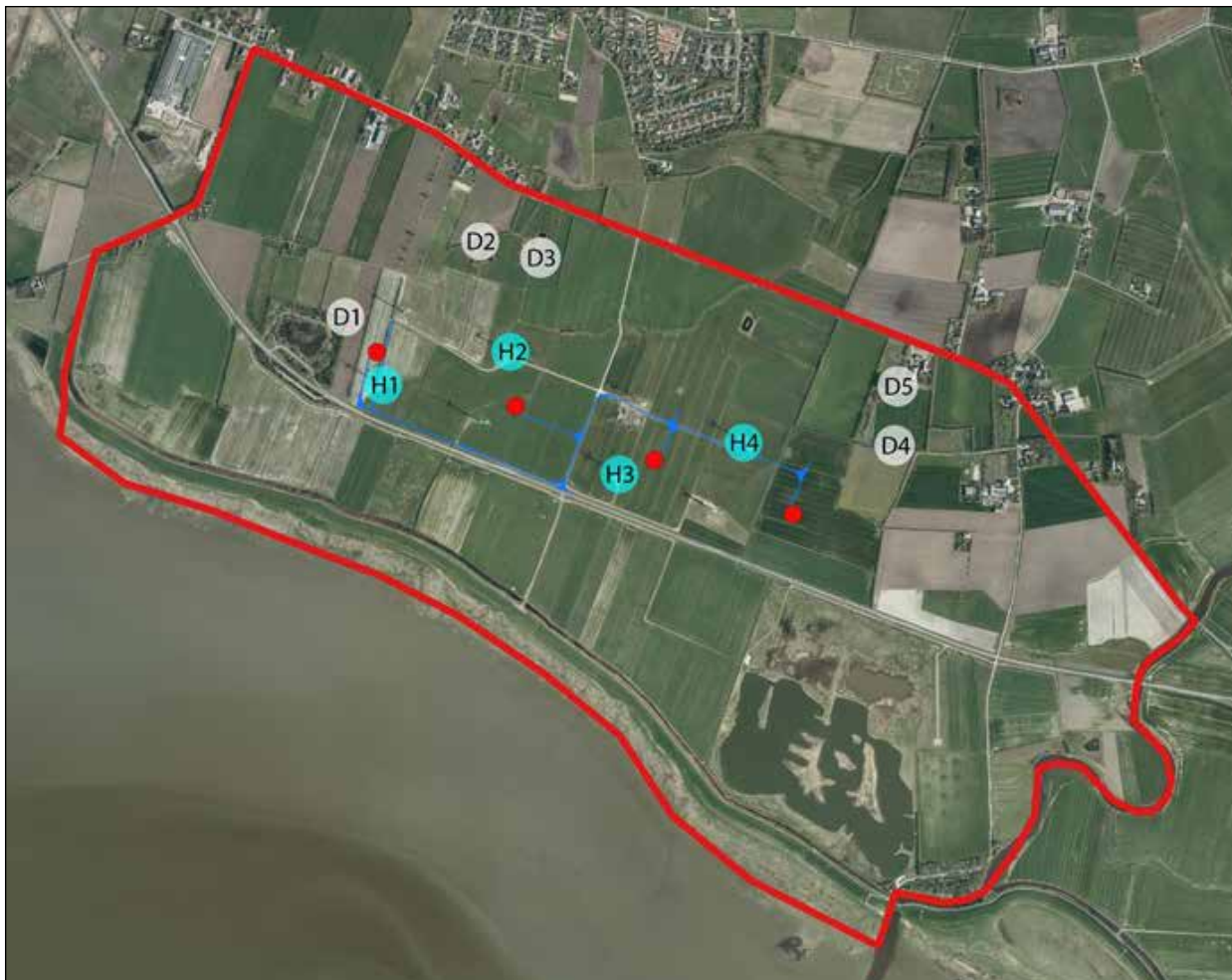
Figur 5.1. Undersøgelsesområdet for naturundersøgelserne (rød afgrænsning) med angivelse af placeringen af de nye møller (røde cirkler), adgangsvejene (blå linjer), de fem stationære flagermusdetektorer (D1-D5) og de fire nuværende vindmøller, hvor der blev lyttet efter flagermus med håndholdt detektor (H1-H4).
