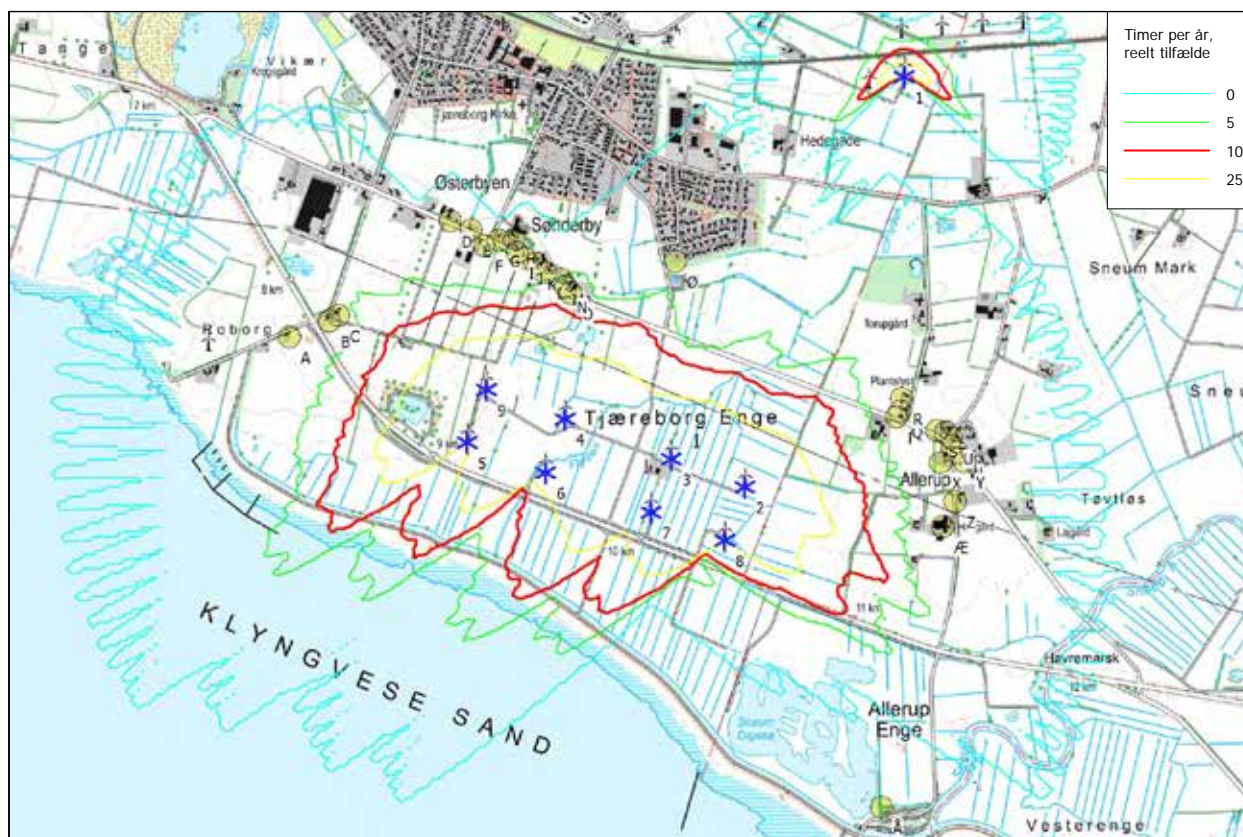
Figur 4.35. Kort over udbredelse af beregnet skyggekast i 0-alternativet med de 8 eksisterende møller i Tjæreborg Enge. Linjerne viser skyggekast i timer pr. år beregnet som reel værdi. Rød angiver grænseværdien på 10 timer pr. år.
