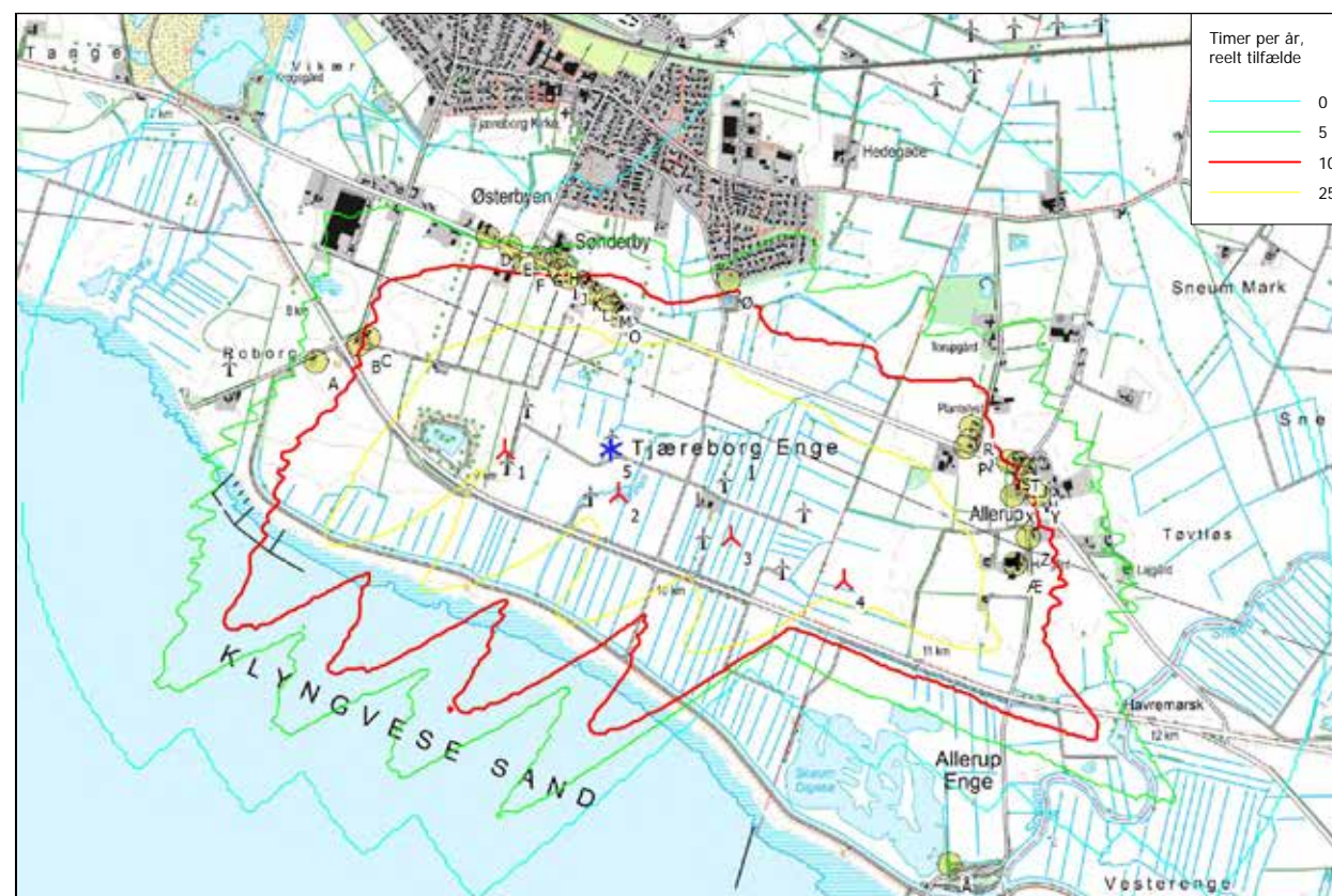
Figur 4.33. Kort over udbredelse af beregnet skyggekast i projektforslaget ved opstilling af Siemens Gama SG155 og nedtagning af syv eksisterende møller i Tjæreborg Enge. Linjerne viser skyggekast i timer pr. år beregnet som reel værdi. Rød angiver grænseværdien på 10 timer pr. år.
