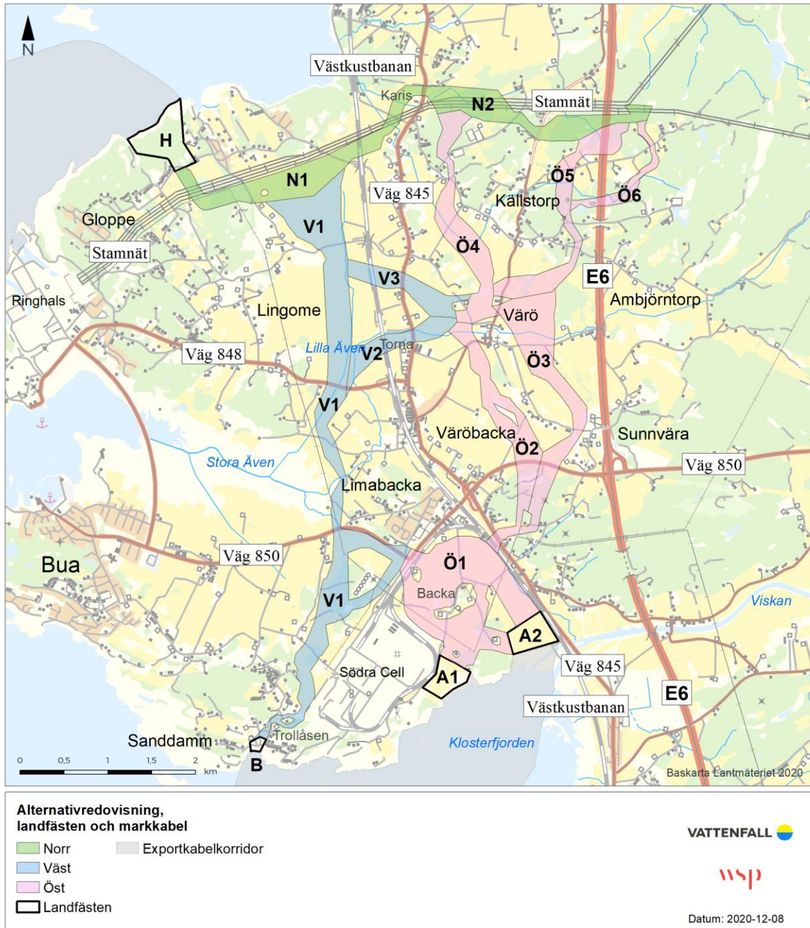
Figur 22. Alternativredovisning av landfästen och utredningskorridorer för markkabel på Väröhalvön.
