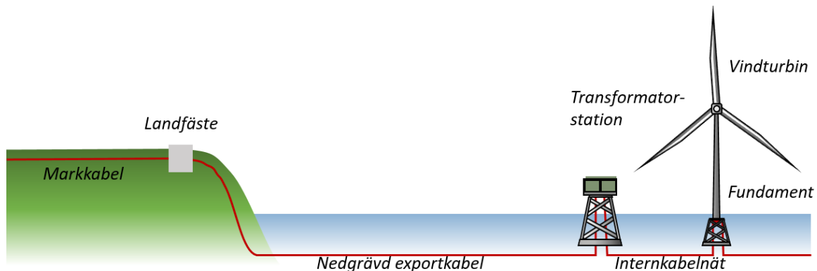
Figur 3. Schematisk bild över en vindkraftpark till havs med alla olika delar som omfattas.
