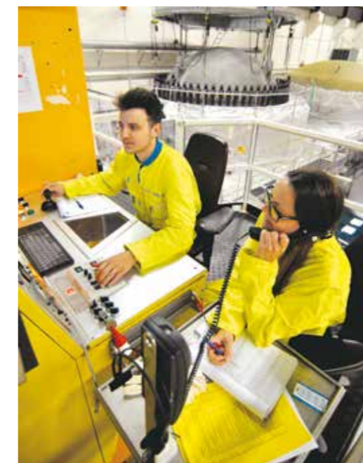
Med laddmaskinen byter Robert Johansson från Westinghouse och Caroline Wass från Forsmarks kraftgrupp bränsle uppe i reaktorhallen. Foto: Alexander Åberg
