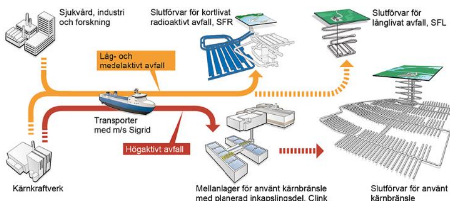
Figur 5. Det befintliga systemet för hantering av radioaktivt avfall och använt kärnbränsle. De blå bergsalarna i SFR, inkapslingsanläggningen invid Clab samt SFL och slutförvaret för använt kärnbränsle är anläggningar som återstår att bygga (Svensk Kärnbränslehantering AB).
