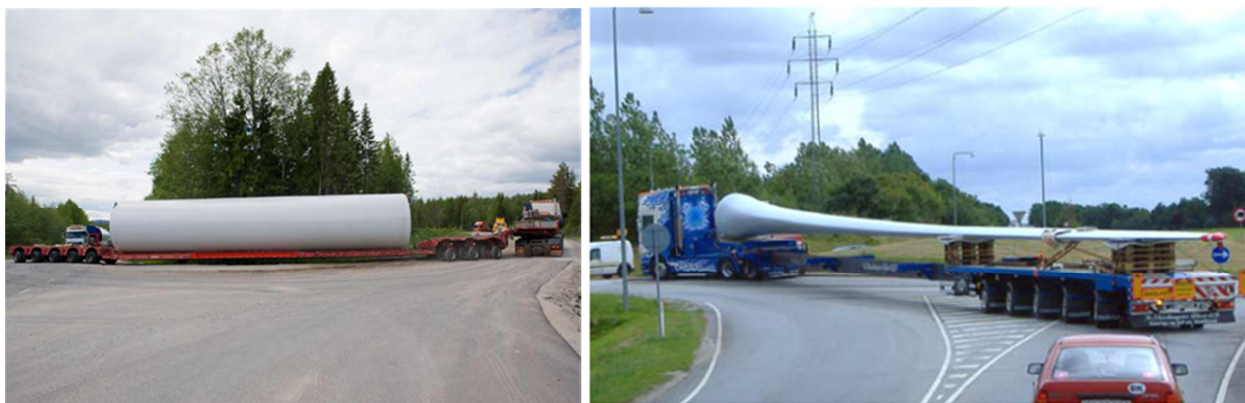
Figur 55 Exempel på ytbehov av fri yta utanför vägen vid kurvor för transporter av torndelar och rotorblad. Källa: Trafikverkets publikation om Transporter till vindkraftsparker
