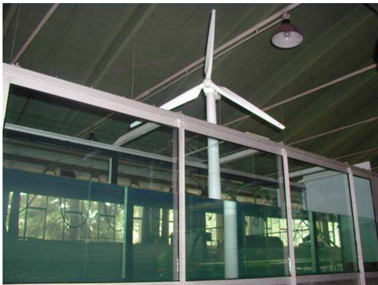
Figur 11. Tank för undersökning av effekten av fundamenten i strömmande skiktat vatten med en modell av en vindkraftanläggning (för land) från Nordex (©P. Menzel, Strömungsmechanisches Institut, Universität Rostock).
