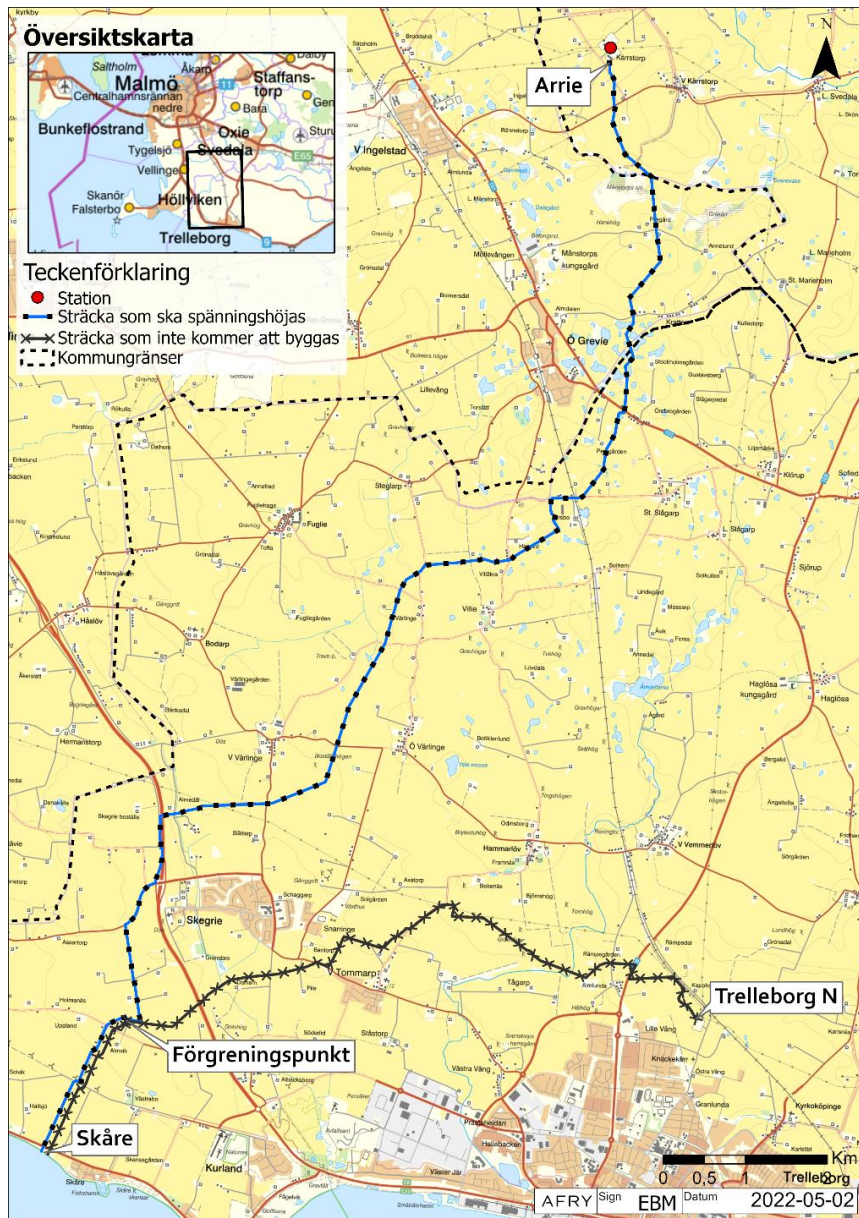
Figur 2: Sträcka som ska spänningshöjas (blå) samt sträcka som utgår till följd av spänningshöjningen (svart överkryssad). Av karttekniska skäl är sträckningarna mellan Skåre och Förgreningspunkt schematiska. För exakt sträckning hänvisas till kartbilagor.
