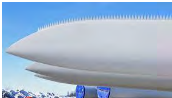
Figur 22. Bild som visar hur vindkraftverkens rotorblad är försedda med fjäderliknande plasttrianglar som minskar ljudet från vindkraftverken.
